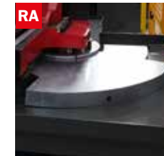
RA Dispositivo rotazione arco Automatic bow mitre rotation
