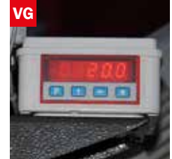
VG Visualizzatore gradi angolo di taglio Cutting angle display
