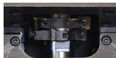
2 Dreh-Fräsköpfe mit je fünf 4-seitigen Wendeschneidplatten
