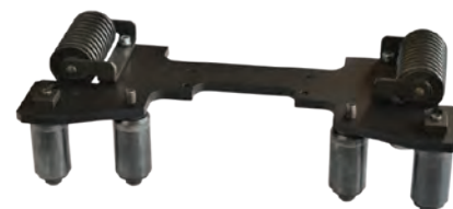
Befestigungen für Anfasen runder Platten: Minimaler Außenradius R = 1000 mm (40") Minimaler Innenradius R = 1000 mm (40")Max. Fasenbreite 19 mm Artikelnummer: ZSP-0539-10-00-00-0
