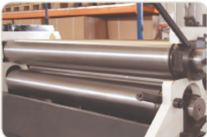
İndüksiyonlu Sert Miller Induction Hardened Rolls
