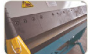
Arkör Kaplama Sert Parçalı Bıçaklar Arcor Nitrocarburized hardened blades
