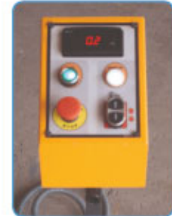
Kolay ayarlanan bükme açısı Easily set bending angle
