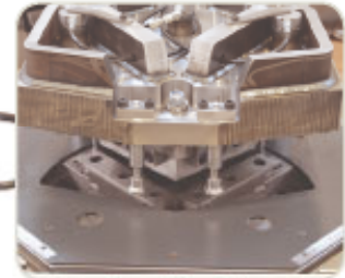
Angle Adjustable Blades Açı Ayarlı Bıçaklar (Standart)
