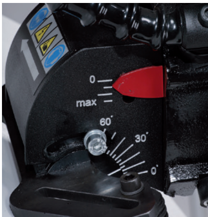
Kontinuierliche Winkeleinstellung von 0 bis 60 Grad.
