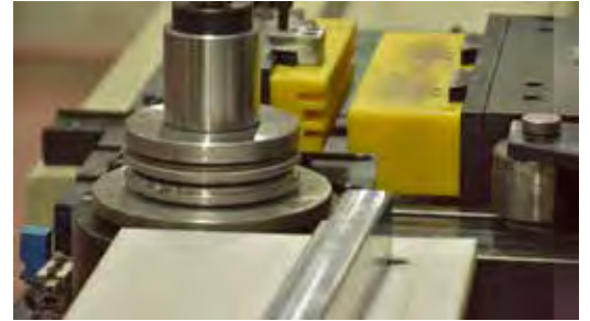
Alüminyum Profile Uygun Özel Kalıplar Special Toolings For Aluminium Profiles
