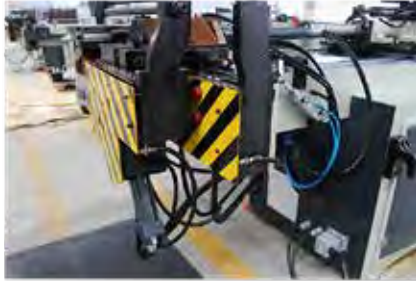
Büküm Kafası Arkasında Güvenlik Sacı Safety Plate on Back Of Bending Head
