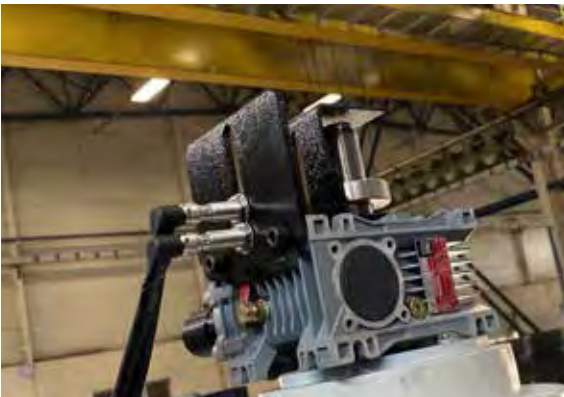
Redüktörlü Motorlu Açı Ayar Sistemi Gear Box Driven Angle Adjustment System
