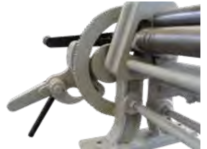
Dişli Ay Çarkı ile hızlı Arka-Top ayarlama With Geared Lock, Easy Backroll Adjustment
