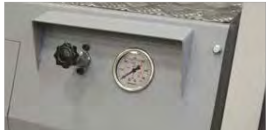
Alt top basınç ayarı Pressure adjustment on bottom roll
