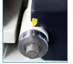
Bıçak Sentil Ayarı Blade Gap Adjustment
